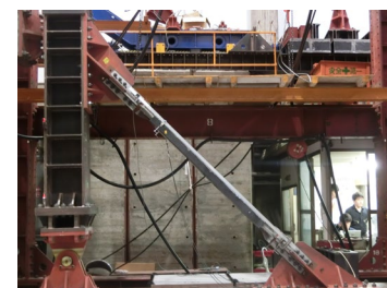
写真1 座屈拘束ブレース
