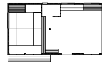
規格型 60 m 2 集会所標準タイプ 平面図
