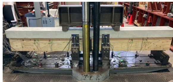
図 3 実験の様子(上：面内せん断実験，下：曲げ実験)
